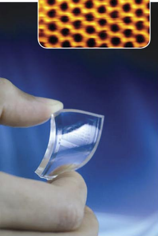
ВРЕМЯ ГИБКОСТИ: прозрачный электрод из слоя углеродных колец, нанесенного на полимер
